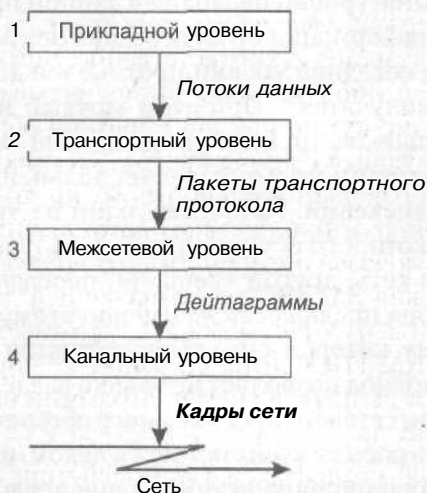
Рис. 2.2. Модель реализации стека протоколов
